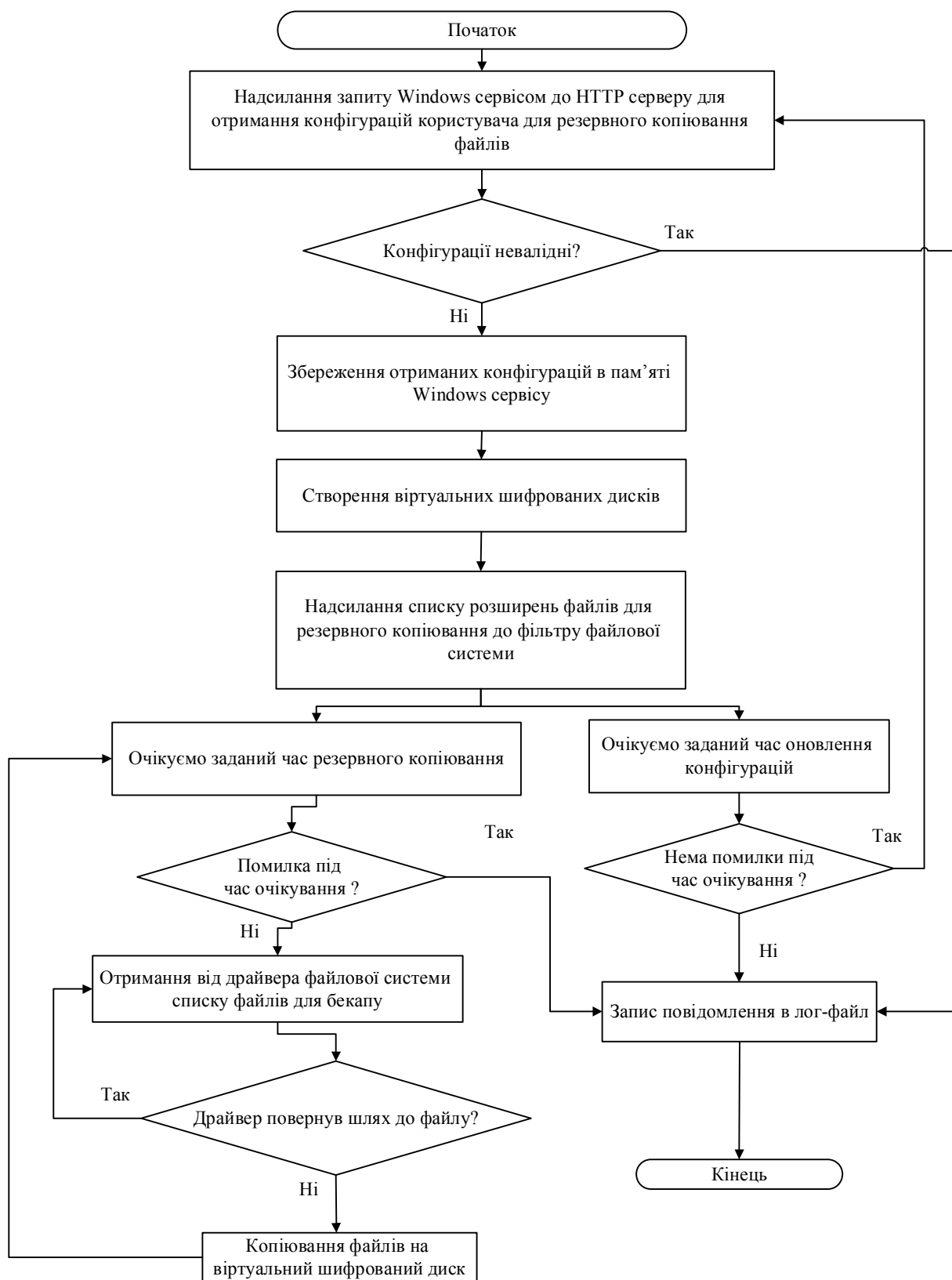
Рис. 2. Схема алгоритму роботи модуля резервного копіювання
