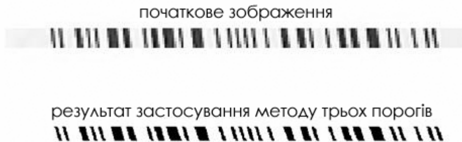
Рис. 8. Приклад підвищення роздільної здатності на межі штрихів і пропусків
