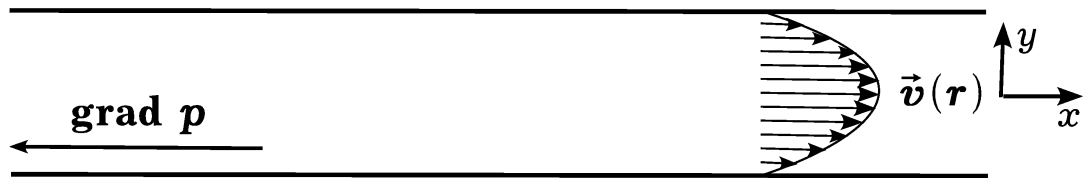
Рис. 1. Розподіл швидкості руху в'язкої рідини між двома паралельними площинами
