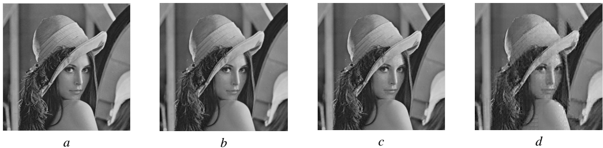
Рис. 4 Результати виконання програми на тестовому зображенні "Lena_gray", розмір блоку зображення 16x16: a – початкове зображення; b, c, d – зображення, відновлені після ущільнення із 10, 9 та 4 нейронами відповідно
