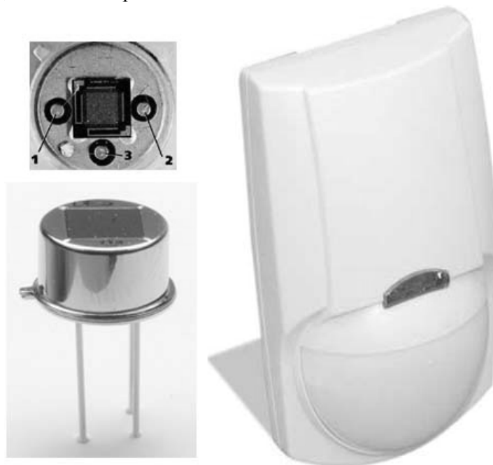
Рис. 12. Піроелектричний сенсор та пасивний інфрачервоний детектор руху, розроблений на його основі
