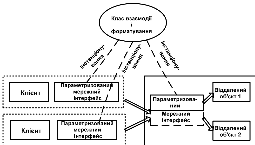
Рис. 1. Схематичне зображення клієнт-серверної взаємодії з використанням параметризованого мережного інтерфейсу
