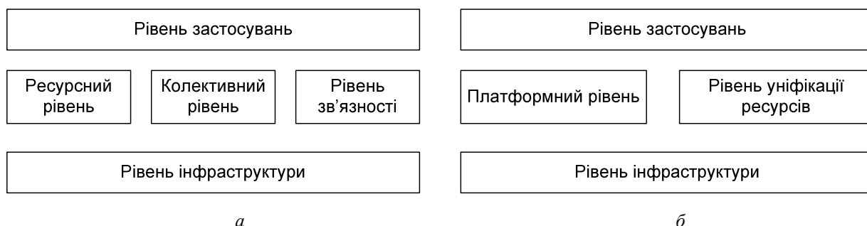
Рис. 9. Порівняння архітектури грід та хмарного обчислення
