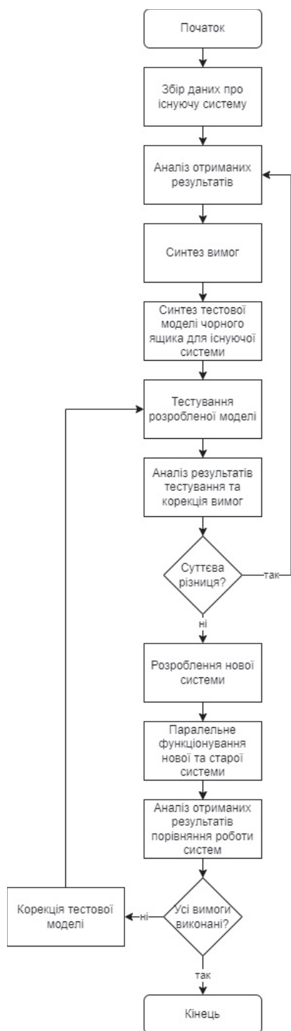
Рис. 3. Блок-схема алгоритму застосування методу розроблення специфікацій та вимог до ІТ-проектів / Flowchart of the algorithm for applying the method for developing specifications and requirements for IT projects
