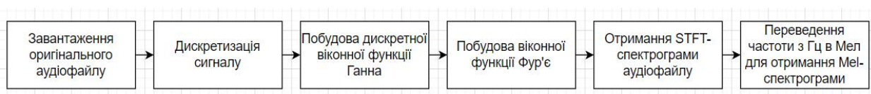
Рис. 3. Етапи перетворення аудіофайлу на спектрограму
