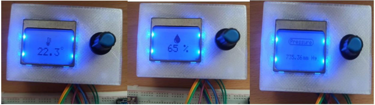
Рис.4. Результати функціонування автоматизованої системи вимірювання температури (а), вологості (б) та атмосферного тиску (в)
