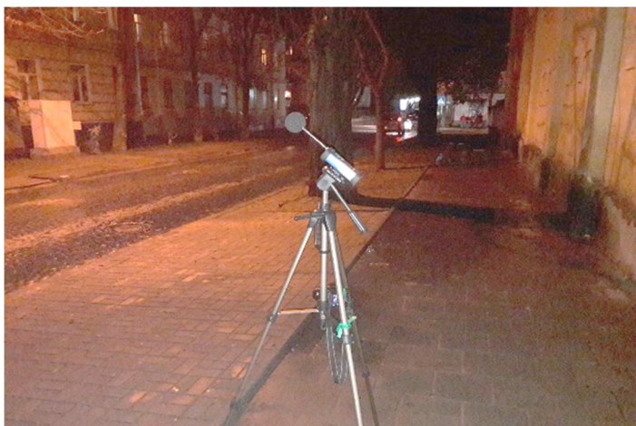
Рис. 1. Вимірювання еквівалентного рівня шуму зранку на вул. Ярослава Мудрого
