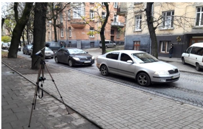
Рис. 2. Вимірювання еквівалентного рівня шуму вдень на вул. Ярослава Мудрого
