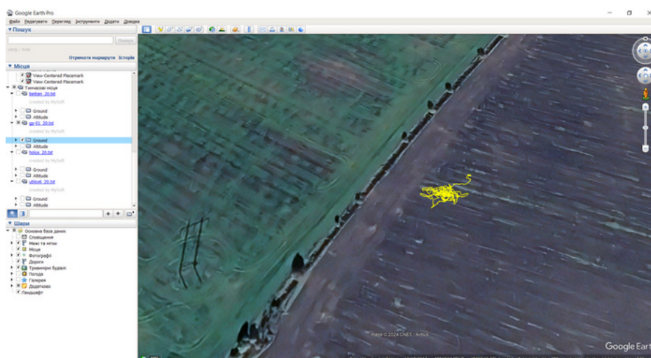
Рис. 12. Візуалізація отриманих з модуля GP-01-Kit координат у статичній точці (МРП не переміщується)
