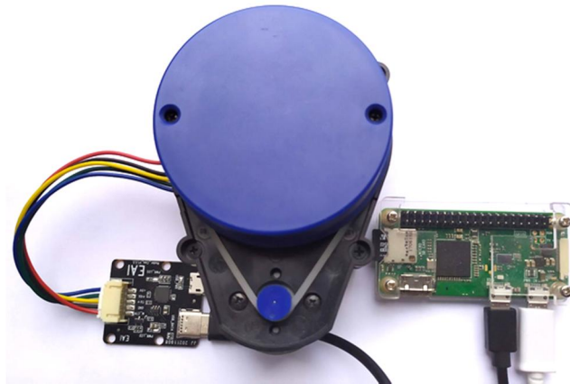
Рис. 6. Модуль лідара YDLidar X4 з мікрокомп'ютером Raspberry Pi Zero W
