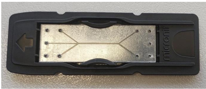
Рис. 8. Спосіб кріплення прототипу мікрофлюїдної структури в тримачі Micronite
