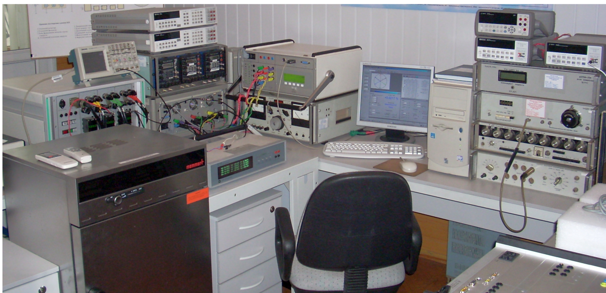
Рис. 2 Зовнішній вигляд Національного еталону України одиниць електричної потужності та коефіцієнта потужності НДЕТУ ЕМ-08-2023
