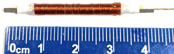
Рис.2. Внутрішня структура параметричного датчика магнітної індуктивності: одношарова котушка, намотана на циліндричний феромагнітний сердечник
