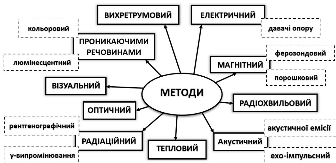
Рис. 1. Методи неруйнівного контролю фізико-механічних характеристик металоконструкцій
