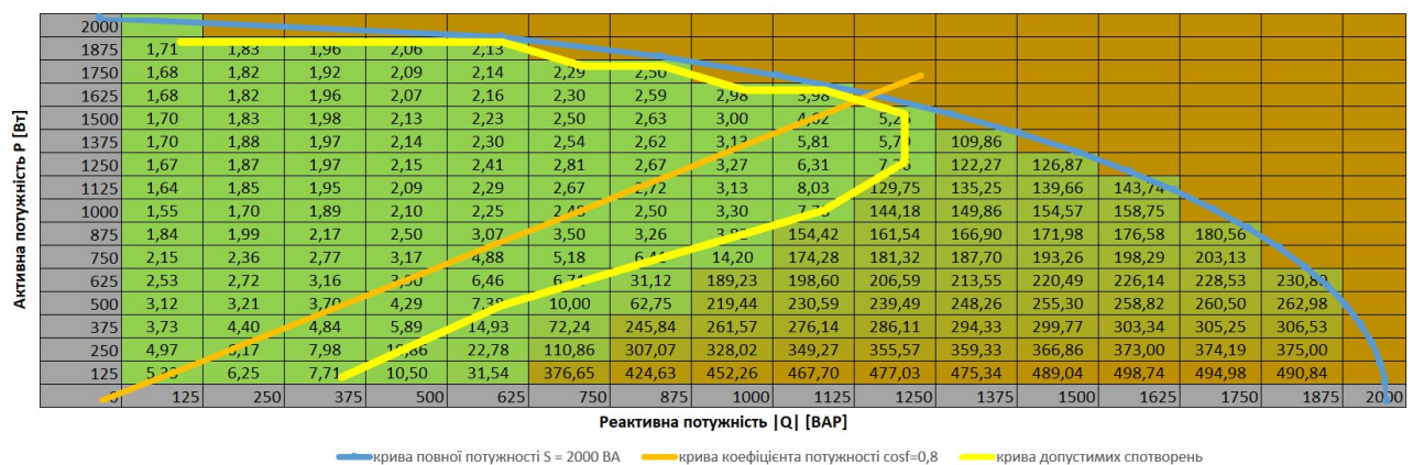
Рис. 7. Результати визначення СКГС и на площині та побудови кривої допустимих спотворень
