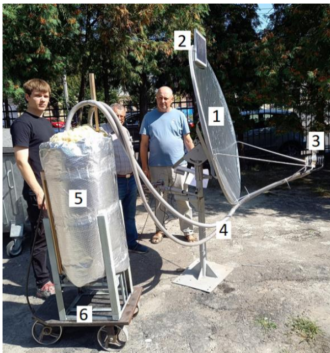
Рис. 6. Загальна структура побутової СВНУ з КСЕ
