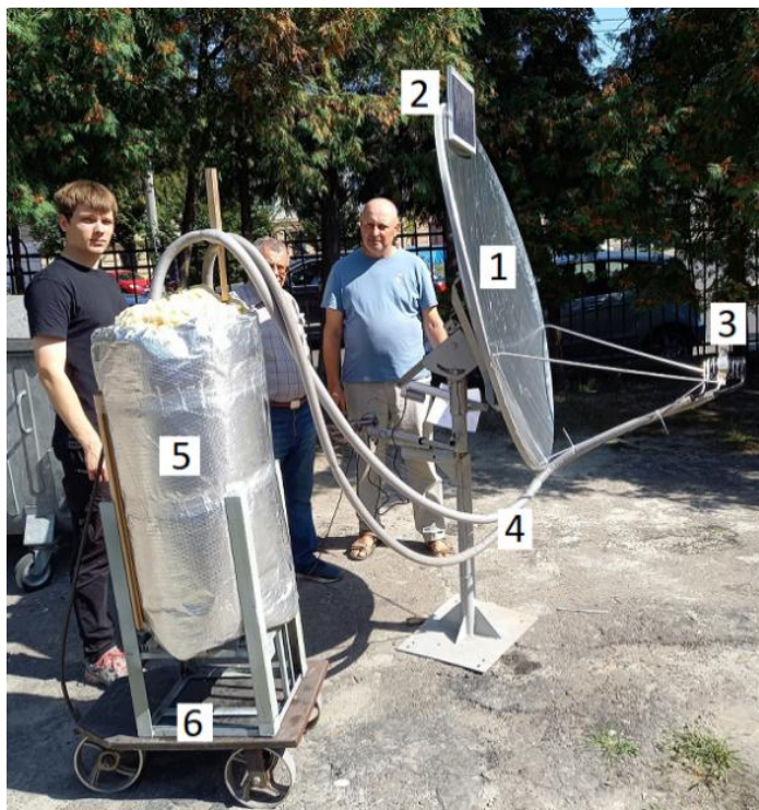
Рис. 6. Загальна структура побутової СВНУ з КСЕ
