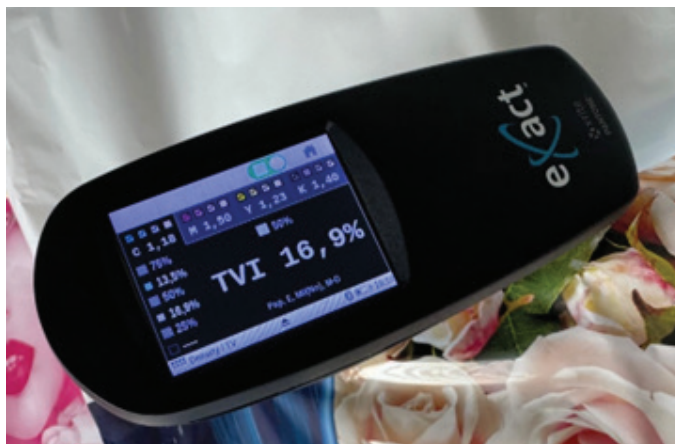
Рис. 3. Вимірювання показників за допомогою спектрофотометра Eхact виробництва X-Rite
