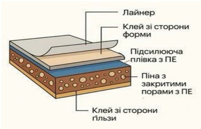
Рис. 1. Структура демпферної монтажної стрічки
