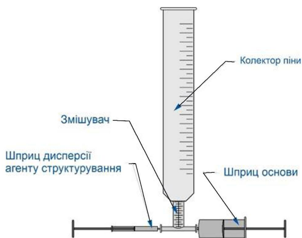
Рис. 1. Схематичне відображення лабораторної установки для отримання макропористих гідрогелів
