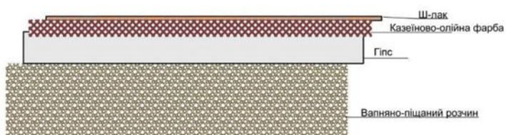
Рис. 13. Результати лабораторного аналізу, їх розшифрування та схематичне відображення автентичної технології мармуризації актової зали НУ «ЛП»
