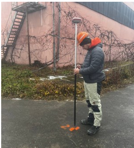
Рис. 3. Фіксація координат контрольних пунктів – пункт 2
