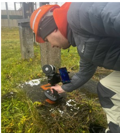
Рис. 5. Фіксація точки сканером
