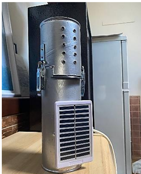
Рис. 6. Виготовлення лампи з тубуса від мінометного снаряду 120 мм
