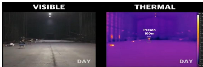
Рис. 1. Порівняння зображень з камери і тепловізора в хорошу погоду
