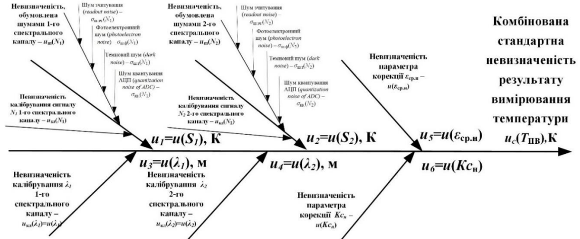
Рис. 2. Діаграма Ісікави для джерел невизначеностей вимірювання температури методами монохроматичної одно- та двокольорової ПВ з корекцією на випромінювальну здатність.
