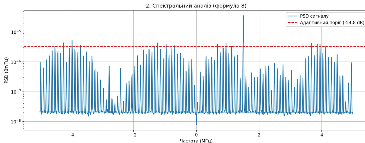
Рис. 5. Спектральний аналіз під час виявлення БПЛА
