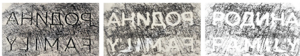
Рис. 4. Резерваж з літографським олівцем на формі до травлення та після травлення і відбиток
