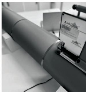
Рис.9. Параметри анілоксового валику за допомогою 3D мікроскопа Trojka Anicam
