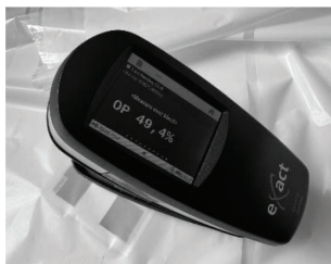
Рис. 7. Фотографія процесу вимірювання непрозорості (opacity) спектроденситометром Ехact виробництва X-Rite
