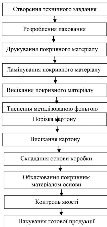
Рис. 1. Блок-схема технологічного процесу виготовлення коробок з картону
