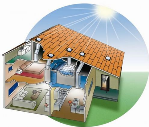
Рис. 1. Світловоди. Тривимірний розріз (Norbert Lechner, 2015)
